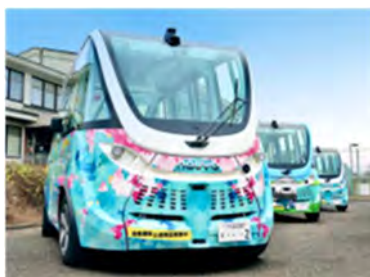
茨城県境町の運転席のない 自動運転車両 (令和 2 (2020) 年 11 月開始)
