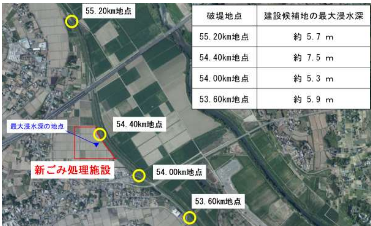
図 5-4 破堤地点毎の最大浸水深
