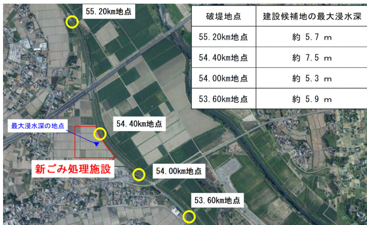
図 5-4 破堤地点毎の最大浸水深
