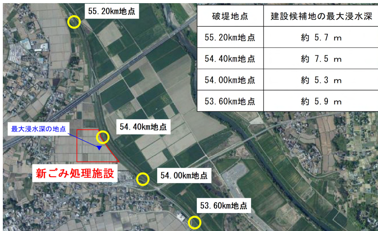
図 5-4 破堤地点毎の最大浸水深
