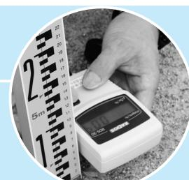
測定器 放射線サーベイメータRDS-30（ミリオンテクノロジー社製）
