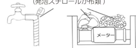
【凍って水が出ないとき】 自然に溶けるのを待つが、蛇口を開け、凍った部分にタオルなどの布をかぶせ、蛇口の方からぬるま湯をゆっくりかけて溶かします。直接熱湯をかけるとひび割れや破裂を起こすことがあるので注意してください。
