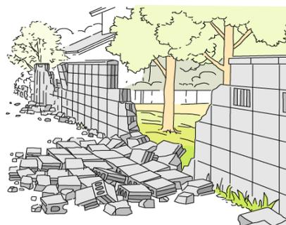
図 地震によるブロック塀の倒壊
